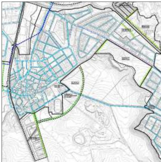
La tubería principal de 400 mm deriva en otra tubería de 300 mm de fibrocemento, que alimenta a los sectores residenciales de La Calzada y Navahonda. Como el plan pretende el desarrollo de sectores que tendrían que ser alimentados desde esta tubería, se propone la sustitución de la misma, por una de fundición de 350 mm de diámetro, que constituiría el eje principal de abastecimiento de agua de Carbajosa.
